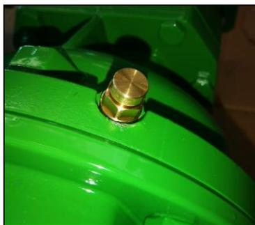
Figura 4-14 Tapón de ventilación por presión
