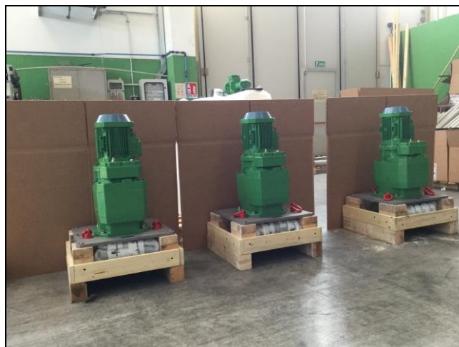
Figura 4-2 Tipo de embalagem para unidade de controlo
