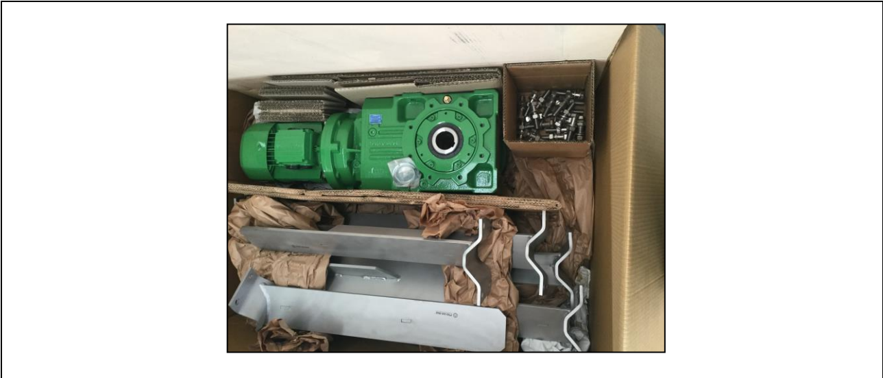
Figura 4-3 Tipo de embalagem para unidade de controlo e impulsore s
