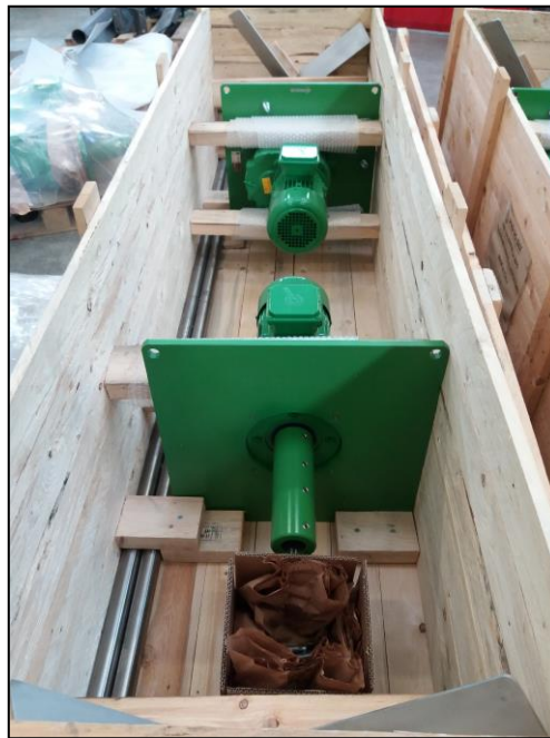
Figura 4-1 Tipo de embalagem em caixa de madeira para agitador completo
