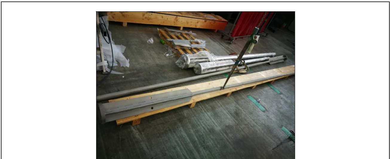
Abbildung 4-5 Handhabung durch Anschlag im Schwerpunkt des Werkstücks
