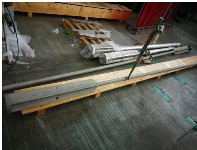
Obrázek 4-5 Manipulace pomocí závěsných popruhů v těžišti součásti
