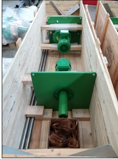
Resim 4-3 Tüm karıştırıcı için tahta kasada ambalajlama örneği
