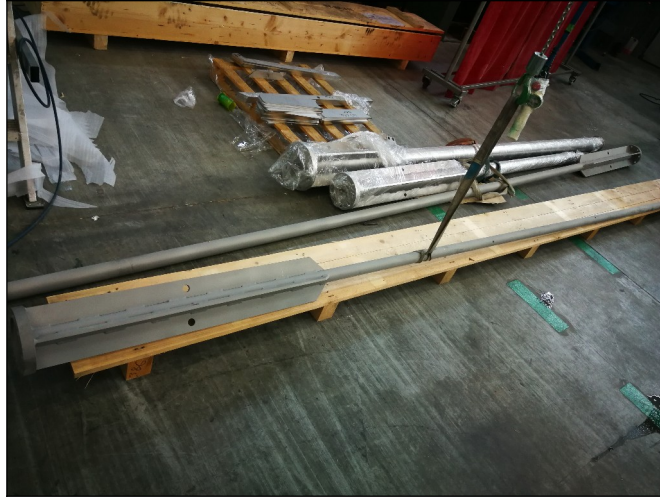
Resim 4-7 Parçanın ağırlık merkezine bağlama yoluyla taşıma
